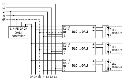
**Función corredor:** sistema para controlar el nivel de luz con un sensor de movimiento convencional conectado en los bornes DALI. Cuando el sensor detecta presencia, el nivel de luz aumenta al 100%, en caso contrario, el equipo mantiene un 10% de nivel de luz.
