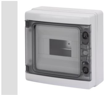
Gama de centralitas estancas IP65 de 4 a 72M con puerta transparente fumé. Las principales características técnicas son: frente y panel trasero reversibles, marcos desmontables, paneles con ventana y puerta que abre hasta 180° equipable con cerradura. Pueden equiparse con repartidores unipolares y bipolares de 80A y 125A, de conexión por tornillo, permitiendo realizar un cableado sencillo y limpio, reduciendo el tiempo de cableado.
