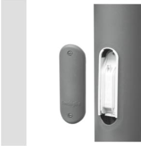
Poste cónico para enterramiento en acero de 3 mm de espesor, galvanizado en caliente y pintado en polvo poliéster. Dotado de dos ranuras (46x186mm) para entrada de cable, con bornero incluido. Puerta de acceso al bornero, pintada en el mismo color que el poste.
